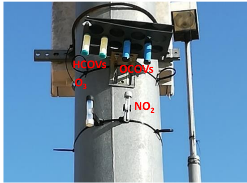
Figura 5. Dosímetros Gradko (para O 3 y NO 2 ) y Radiello (para COVs) instalados en un emplazamiento de medida.
